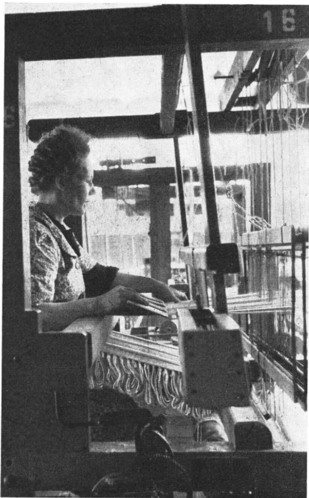
Aus einer Kette wird der Grund des Parkettwischers gewebt, ein festes, glattes Gewebe, welches einmal den Fransen den Halt gibt und zum anderen mit Schnüren versehen, zum Befestigen an einem Besenholz dient. Aus der zweiten Kette werden die losen Fransen gewonnen, die mit dem Grund oben fest verwebt sein müssen.
