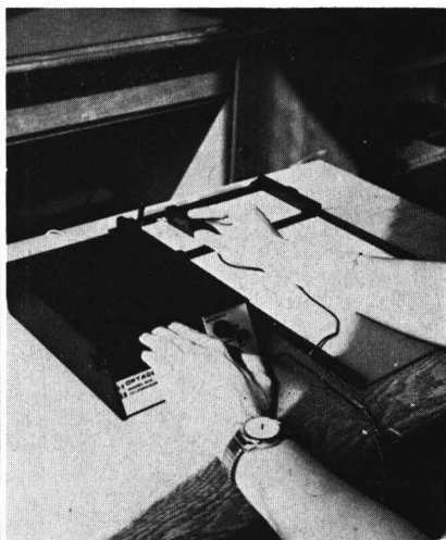
Das „Optacon“ — Eine kleine Kamera setzt Schwarzschriftsymbole in fühlbare Zeichen um, die mit dem Zeigefinger der linken Hand „gelesen“ werden
