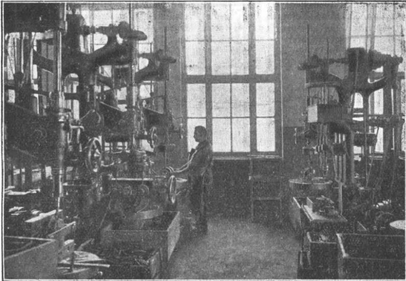
Drei große halbautomatische Bohrmaschinen werden zugleich von einem Blinden bedient. Gusskörper einlegen und bohren. (8 Löcher)
