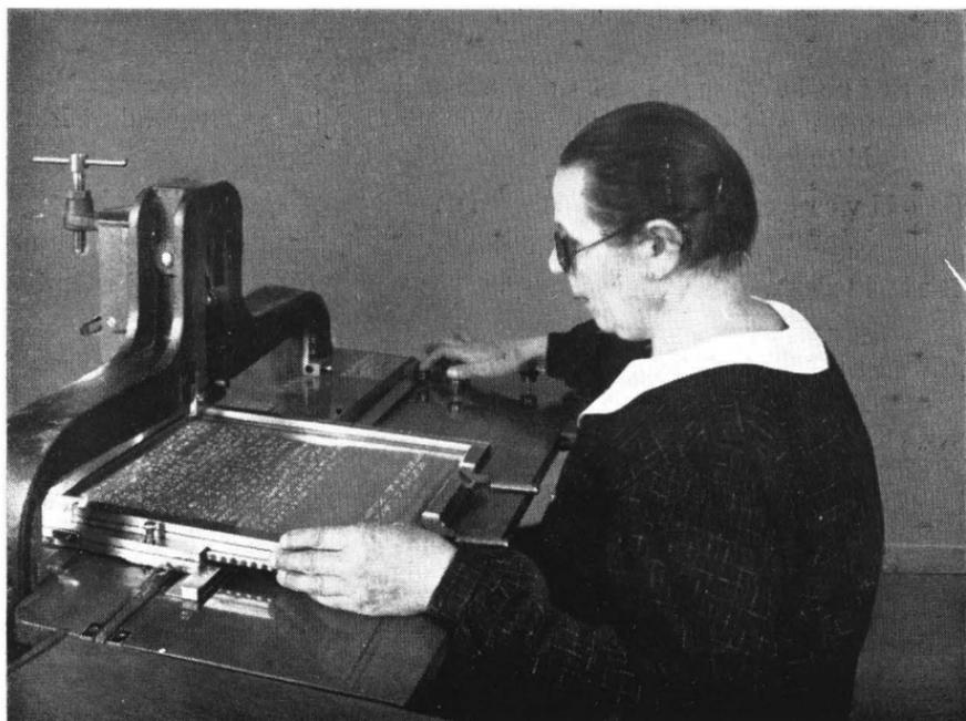
Punzmaschine zum Herstellen der Druckplatten für Blindendruckbücher und -zeitschriften — Provinzial-Blindenschule Paderborn
