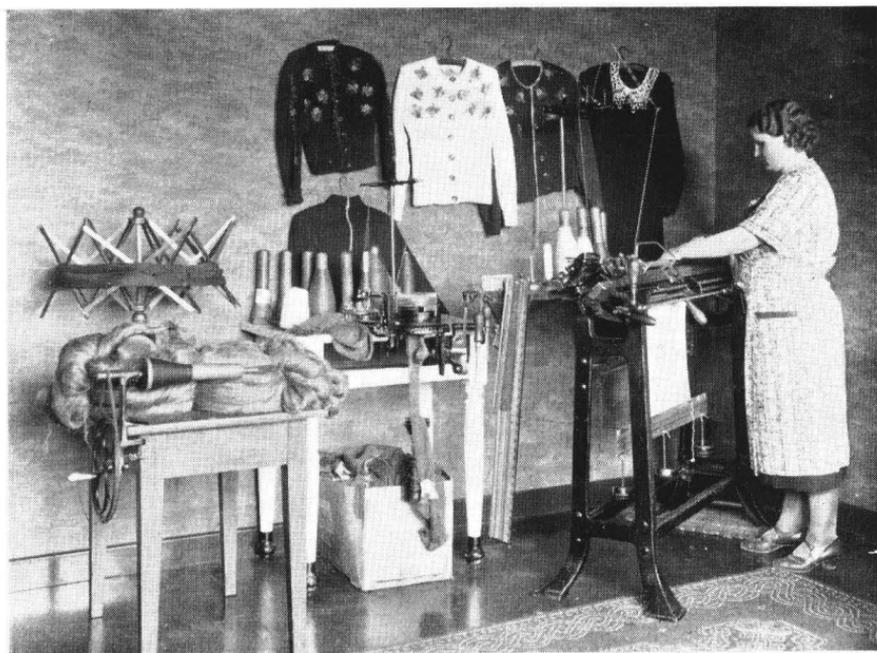
Stricken auf der Flachstrickmaschine — Die einzelnen Teile werden nach Fertigstellung zusammengenäht
