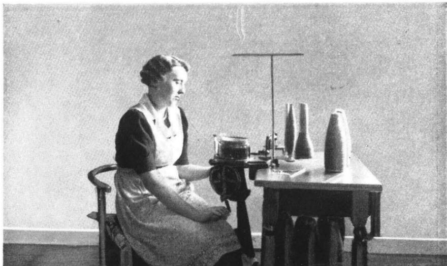
Stricken von Socken auf einer Rundstrickmaschine
