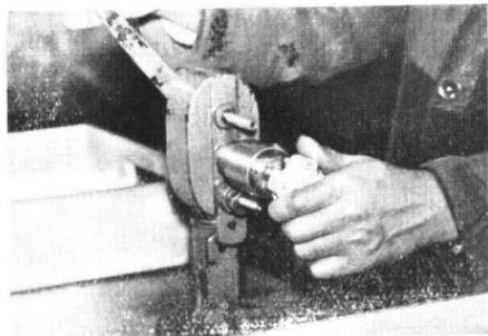
Innenteile und Spannkraft prüfen
